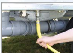
Einfacher Bajonettanschluss für die Frischwasserzufuhr
