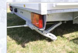
Ausfahrbare Stützen sorgen für einen festen Stand
